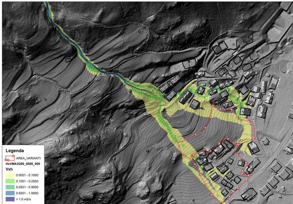
Fig. 4.12 – Massima forza di trascinamento (HxV) della corrente simulata TR 200 anni per fenomeno di colata di detrito ( C_{eq} 0.585 – S 0.05 m)
